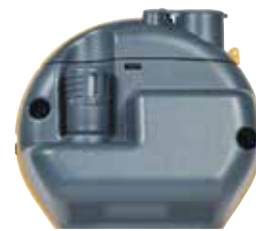
Quikstick ST POL78751, standaard bij alle MMS2-sets en levert dezelfde prestaties als de standaard Quikstick. Een Quikstick ST kan aangesloten blijven op de MMS 2 terwijl u de naaldelektrodes gebruikt.
